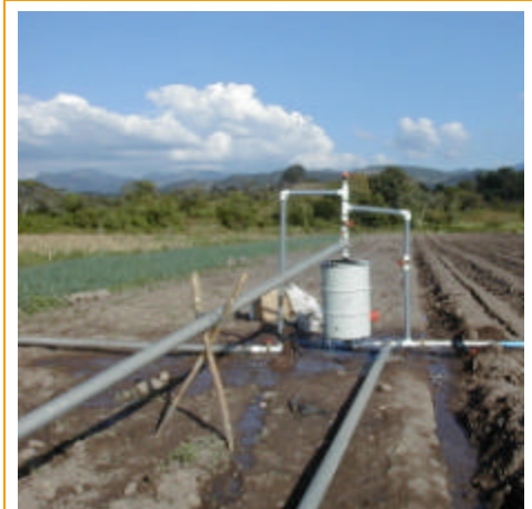
Sistemas de riego por goteo de bajo costo para 80 pequeños productores con filtro de arena diseñado por el CDA.
