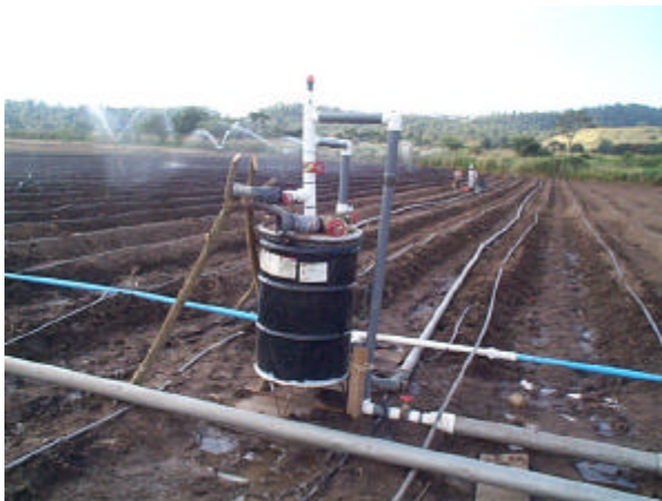
Diseño y construcción por técnicos de CDA de un filtro de bajo costo para riego
