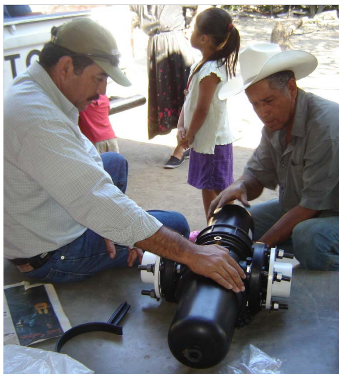
Armado de filtro de anillos, Francisco Morazán
